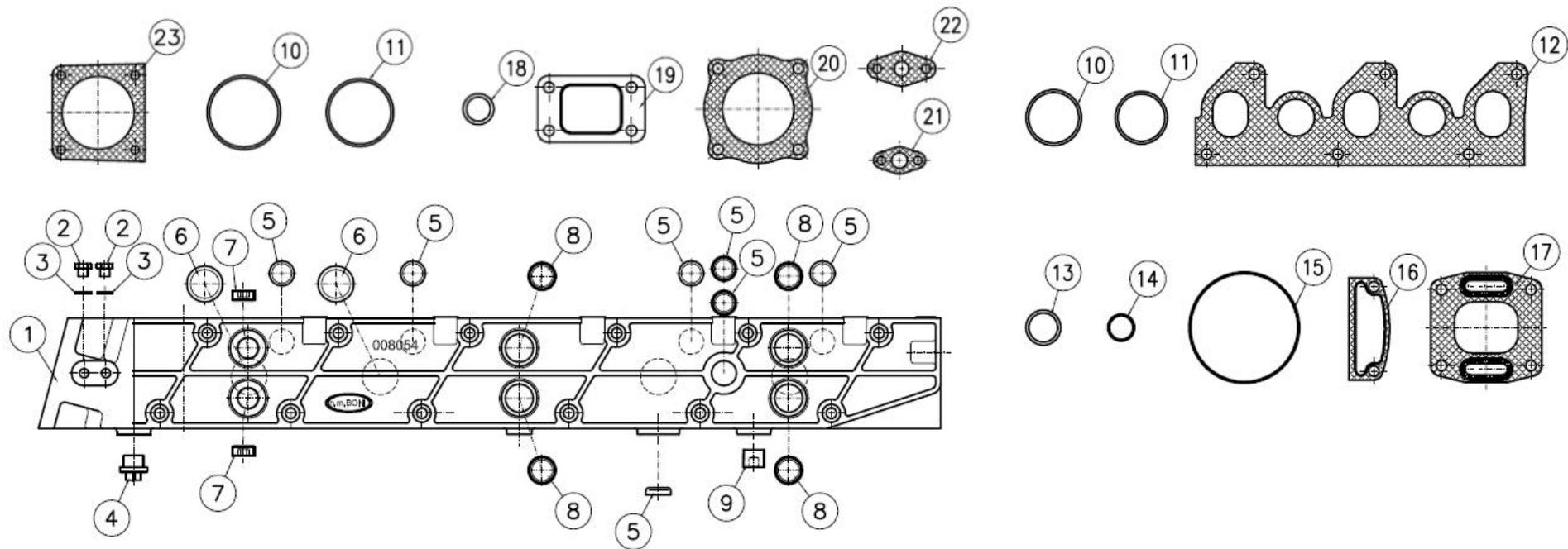
**SCAMBIATORE DI CALORE COMPLETO CON GUARNIZIONI E OR**
