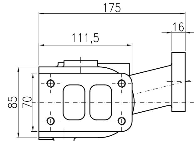
**DIMENSIONI COLLETTORE SCARICO PER MOTORE 2712**
