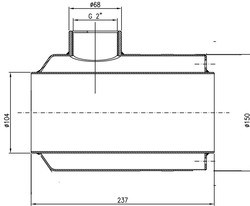
RISER SCARICO DIAMETRO 150 MM ACCIAIO INOX
